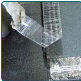
Exclusivo proceso industrial para hacer adhesivo el orillo de superposición longitudinal y transversal.
